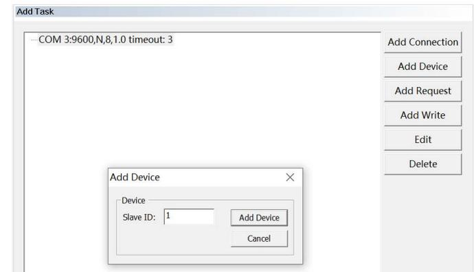
③ Add Request: 选中“Device: 1”，点击“Add Request”，建立状态读取指令，根据设备协议，选择相应的功能、地址和数量：
